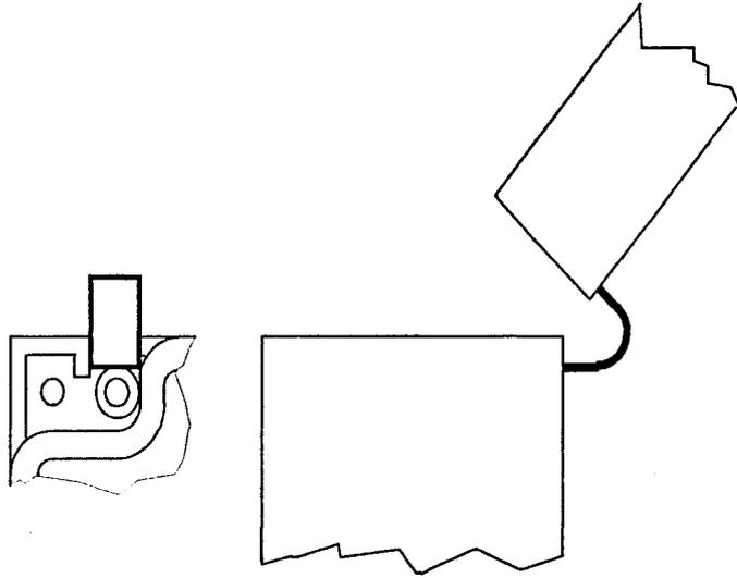
**Рисунок 16** – Крепление крышки вычислительного блока с помощью фиксатора.
