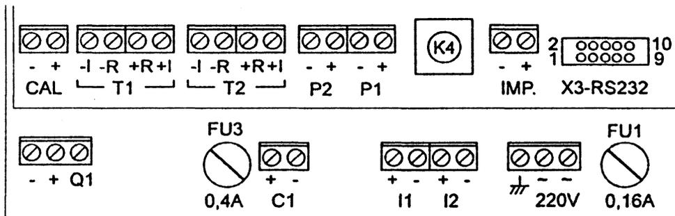
**Рисунок 17** – Расположение клемм вычислительного блока.
