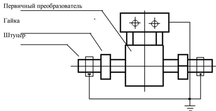
**Рисунок 14** – Схема заземления первичных преобразователей
