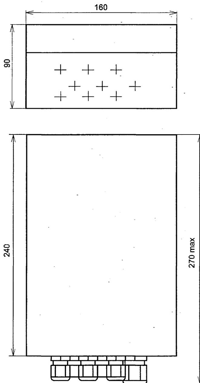
Рисунок 4 – Габаритные размеры вычислительного блока.
