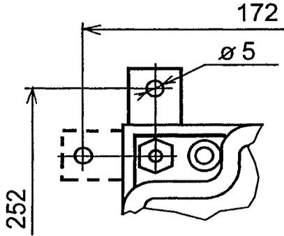
**Рисунок 12** – Варианты установки кронштейнов при креплении вычислительного блока.
