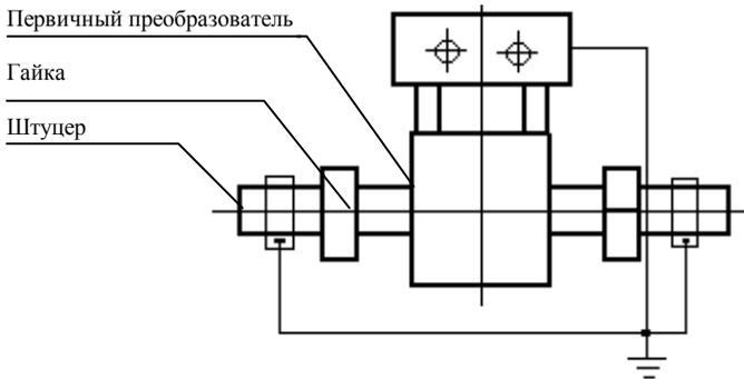
**Рисунок 14** – Схема заземления первичных преобразователей
