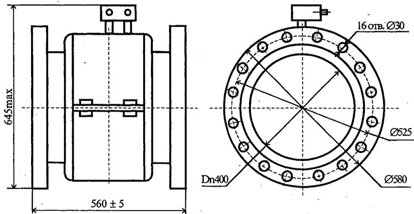
Присоединительные размеры фланцев по ГОСТ 12815-80 исполнение 1 на условное давление  $P_y$  1,6 Мпа (16 кгс/см<sup>2</sup>), конструкция фланцев по ГОСТ 12820-80.
