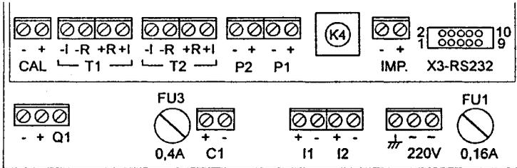
Рисунок 17 – Расположение клемм вычислительного блока.
