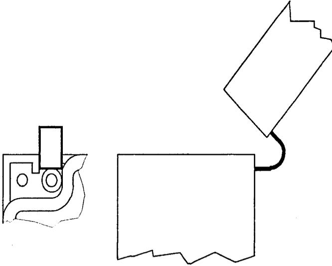
**Рисунок 16** – Крепление крышки вычислительного блока с помощью фиксатора.
